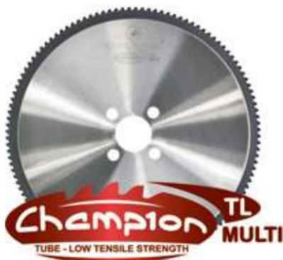
Une lame de scie spécifique Champion TL Multi a été développée pour la coupe multiple de tubes avec une résistance à la traction de  $400$  à  $800 \text{ N/mm}^2$ . Ce type de lame est spécifiquement adaptée pour les machines Rattunde Twin, mais aussi pour d'autres applications où de multiples tubes sont coupés, tels que les machines BEWO, RSA et Sinico. Nos experts en coupe peuvent vous conseiller concernant les paramètres idéaux pour votre application spécifique.
