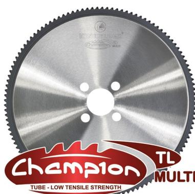
A serra Champion TL Multi foi desenvolvida especificamente para corte múltiplo de tubos com uma resistência à tração de 400 – 800 N/mm<sup>2</sup>. Este tipo de lâmina é especialmente adequado para máquinas Rattunde Twin, mas também para outras aplicações em que vários tubos estão sendo cortados ao mesmo tempo, como ocorre nas máquinas BEWO, RSA, Soco e Sinico.
