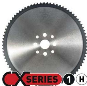
Com a aplicação do novo design do corpo, novas geometrias dos dentes e do novo tipo de revestimento PVD, a serra CX 1-H foi especialmente projetada para o corte de barras sólidas de aço carbono de alta resistência à tração (> 900 N/mm<sup>2</sup>, conteúdo de carbono ≥ 0,60%) com alto volume de produção. Ela também é adequada ao corte de barras sólidas de aço inoxidável ferrítico, martensítico ou duplex com diâmetros maiores que 35mm.
