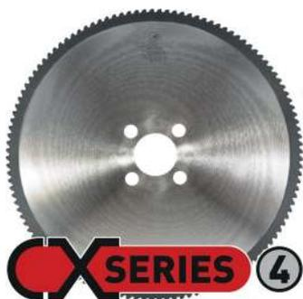
O elevado teor de níquel dos tubos de aço inoxidável austenítico dificulta o seu corte com as lâminas de serra HSS. Com a geometria de dente específica da aresta de Metal Duro revestido com PVD, a serra CX 4 proporciona um acabamento superficial perfeito e extremidades de tubo sem rebarbas.
