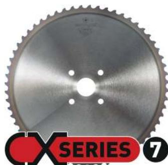
As serras CX 7, com dentes com insertos de Cermet, recobertas com revestimento PVD, foram desenvolvidas para cortar barras sólidas de aço carbono (conteúdo de carbono  $< 0.60\%$ ) com resistência à tração média de até 750 N/mm<sup>2</sup>. Os melhores desempenhos dessa serra são atingidos no corte de materiais de baixa resistência à tração. Em várias aplicações, uma vida de 50m<sup>2</sup> ou mais pode ser atingida.
