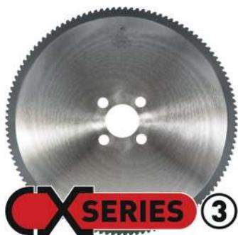
A lâmina de corte CX 3 foi desenvolvida para o corte de tubos em máquinas de corte automático de alta performance, com uma velocidade de corte máxima superior à das lâminas de serra HSS. É mais eficaz em serras máquinas com controle preciso de carga e taxa de alimentação variável.
