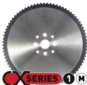
As serras CX1-M, com dentes com insertos de Metal Duro, recobertas com revestimento PVD, foram desenvolvidas para cortar barras sólidas de aço carbono (conteúdo de carbono < 0,60%) com uma resistência à tração média entre 500 e 900 N/mm<sup>2</sup>, com alto volume de produção.
